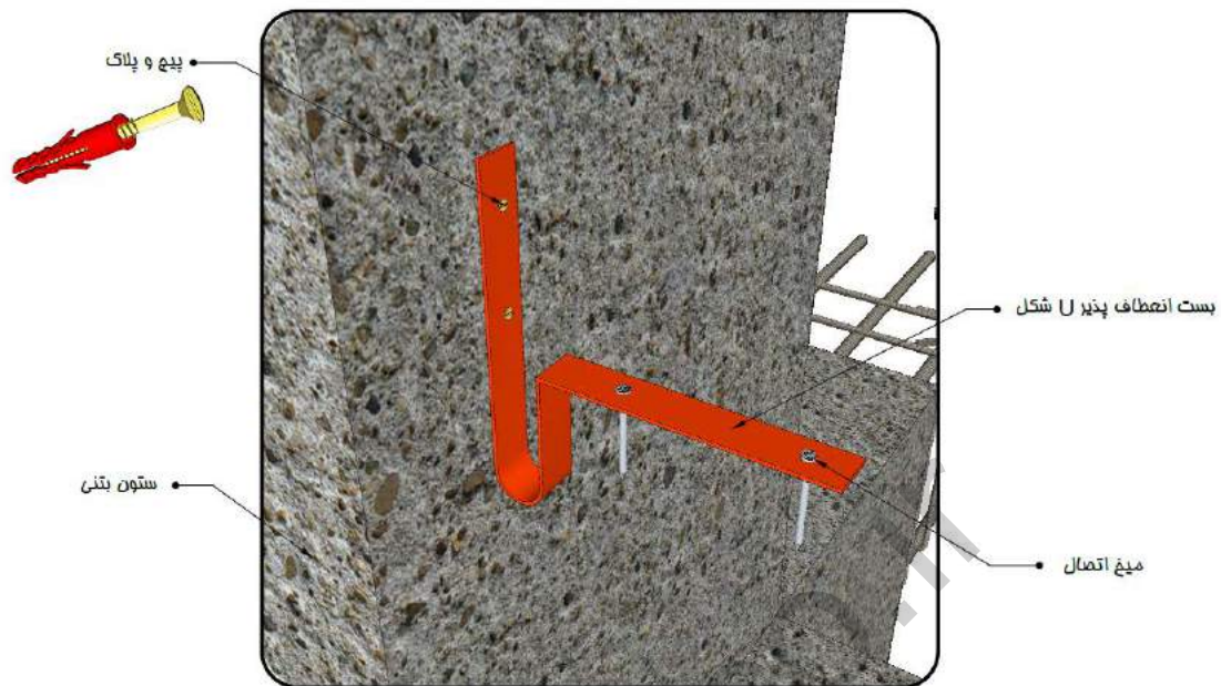
الف- اتصال دیوار خارجی ساخته شده از بلوک به ستون با استفاده از بست ارتجاعی U شکل
